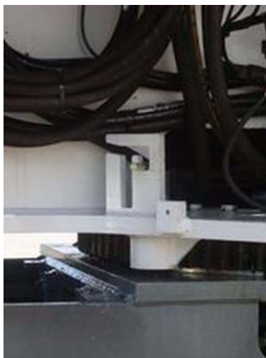
Контактный замок поворота (Пожалуйста, смотрите конфигурацию подъемника)
